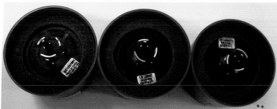
Figura 10 – Amostras (26655 J, 26655 K, 26655 L) após ensaio de Aderência da Gaxeta
